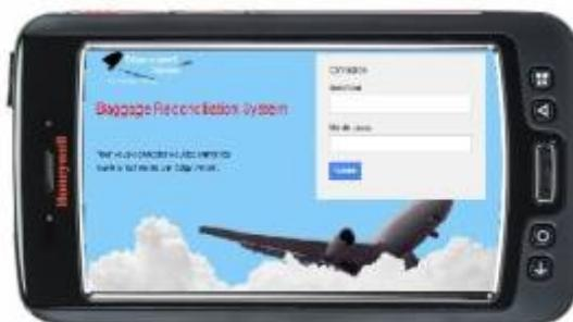
Grâce à l'utilisation de terminaux mobiles munis de scanners à codes à barres, les bagagistes ont accès aux informations en temps réel qui les aide à localiser des bagages, charger ou décharger des conteneurs (ULD, Unit Load Device), etc.
